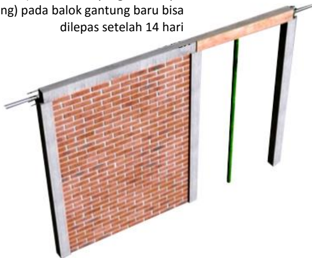
Gambar 61. Pelepasan Cetakan/ Bekisting
