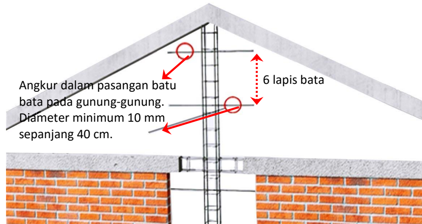
Gambar 52. Hubungan Angkur Pada Gunung-Gunung/ Ampig
