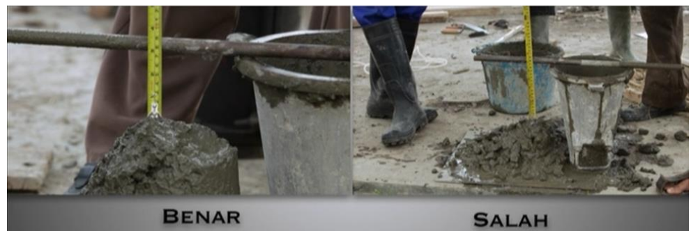
Gambar 4. Pengujian Sederhana Dengan Menggunakan Cetakan dan Mengukur Selisih Ketinggian dengan Cetakan
