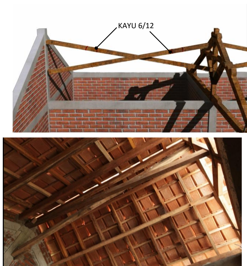
Gambar 36. Ikatan Angin Antara Kuda-Kuda Kayu dengan Gunung-Gunung/ Ampig
